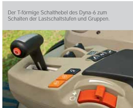
Der T-förmige Schalthebel des Dyna-6 zum Schalten der Lastschaltstufen und Gruppen.
