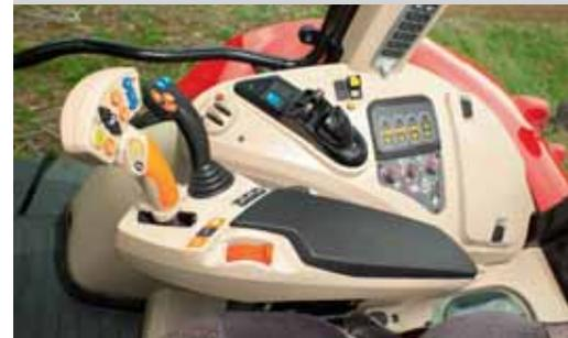
Getriebe-Steuer-Modul mit Tasten für DTM und Fahrstrategie sowie 2 Drehregler für Einstellungen.
