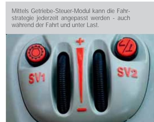
Mittels Getriebe-Steuer-Modul kann die Fahrstrategie jederzeit angepasst werden - auch während der Fahrt und unter Last.
