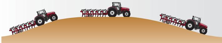
Bergauffahrt: Traktor hält Geschwindigkeit und erhöht die Drehzahl
